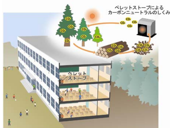
バイオマスエネルギー利用のペレットストーブ
